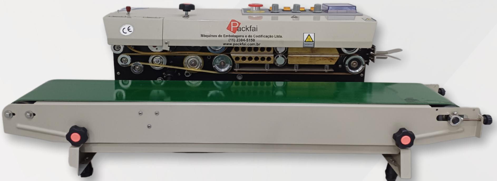
A Seladora Continua é construída em aço inox ou aço carbono adotando temperatura constante, velocidade ajustável e mecanismo flexível, capaz de selar qualquer tipo de filme sendo utilizada em diversas áreas, tais como: farmacêutica, alimentícia, química, têxtil, congelados, cosméticos etc.
